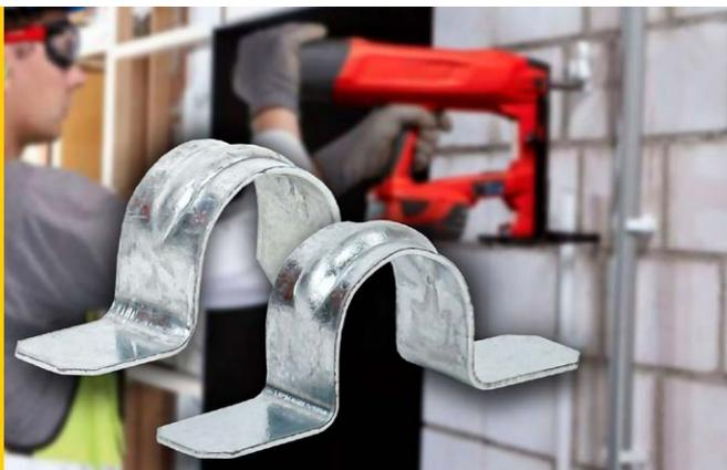
Обеспечивают быстрый, удобный и надежный монтаж металлорукавов и труб различных исполнений. Использование монтажного пистолета и скоб без отверстий позволяет в несколько раз увеличить скорость монтажа, по сравнению с классическими скобами с отверстием.
